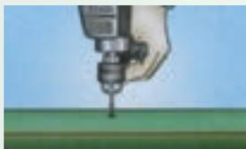
1. Hacer un agujero en la tubería de 6 mm o 10 mm según sea necesario.
