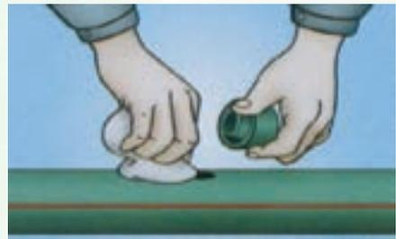
2. Limpie el orificio con un trozo de tela o una servilleta. La superficie de fusión tiene que estar limpia y seca. Para tubos de compuesto Stabi. Elimine el resto de aluminio que permanece en el orificio perforado.
