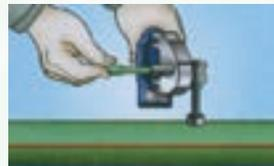
3. Ajustar la profundidad de la fusora cambiando la posición del anillo de distancia, de acuerdo con el espesor de la pared de la tubería. Una vez que la fusora está activada espere hasta que la herramienta de reparación alcance la t° de traba. Empuje la fusora con el anillo de la reparación de dimensión en el orificio de la tubería y la barra para reparaciones en la otra herramienta. **Caliente el agujero y el tarugo durante 5 segundos.**
