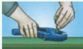
5. Cuando se enfríe la unión hacia abajo, corte la parte no utilizada del tarugo. Cuando el equipo ya no se va a utilizar, se recomienda que apague y deje que se enfríe con el fin de almacenarlo.
