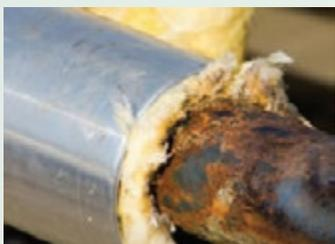
Corrosión causada por condensación en tubería con aislación externa.
