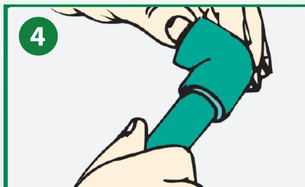
Transcurrido el tiempo de calentamiento retire el tubo e insértelo en la conexión sin pérdida de tiempo.
